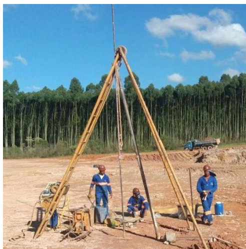
Figura 3 Sondagem SPT.
