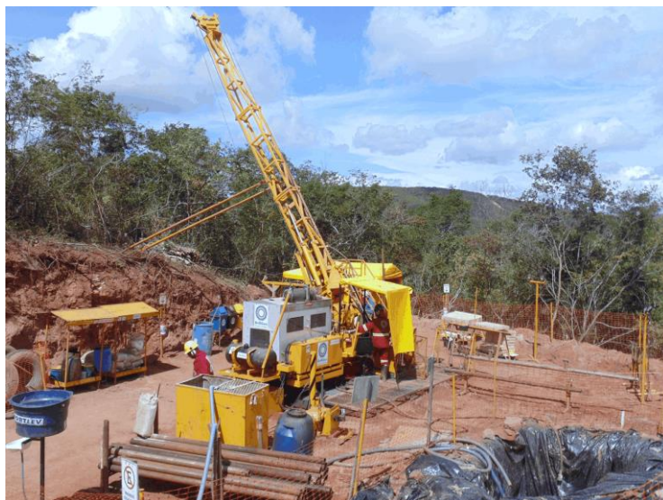
Figura 4 Sondagem rotativa em solo.
